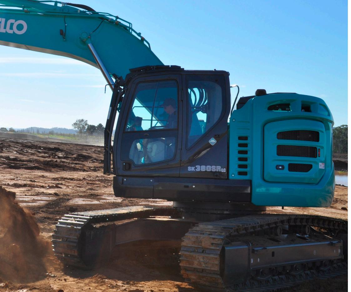
agglomération, c'est sa compacité et ses excellentes performances de levage et d'excavation qui séduisent (une capacité de levage en frontal à 6 m au niveau du sol de 12390 kg, un rayon de rotation arrière de 1900 mm et un rayon de rotation avant de 3450 mm). Construite sur un châssis HD de 5 m de long qui lui confère davantage de stabilité, la machine bénéficie
