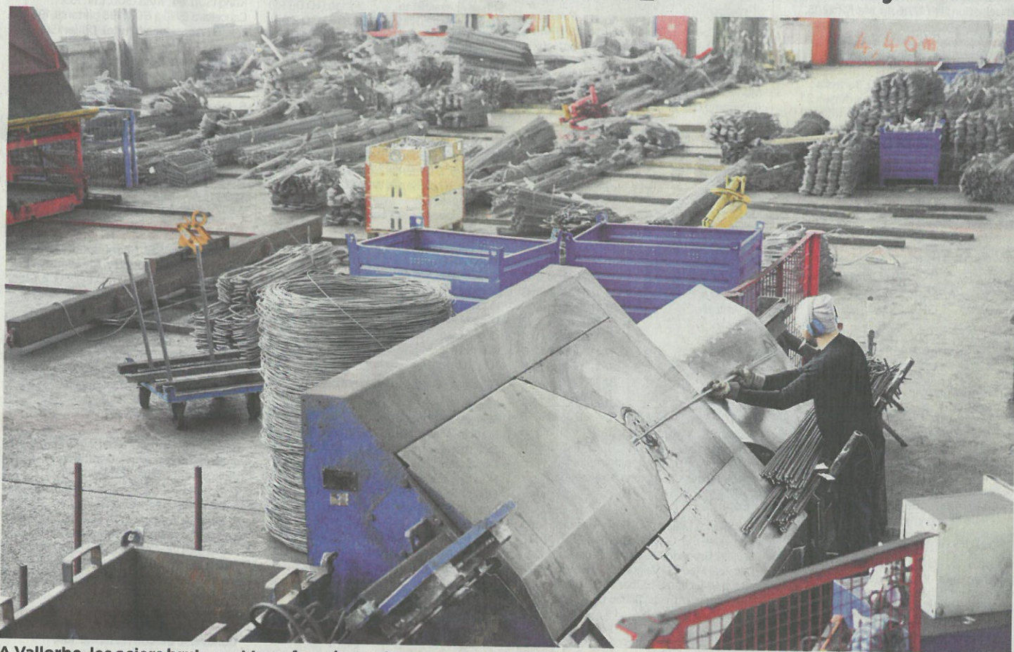
A Vallorbe, les aciers bruts sont transformés sur d'imposantes machines de coupe et de pliage OLIVIER ALLENSPACH
